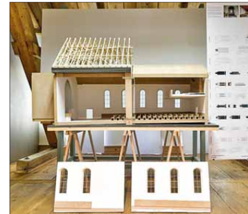
Das Modell der evangelischen Kirche Schwanden (1753) von Jakob und Hans Ulrich Grubenmann zeigt die Möglichkeit, Innenraum („Bauch“) und Außengestaltung („Mantel“) in Kombination mit der Dachkonstruktion besser zu verstehen.
